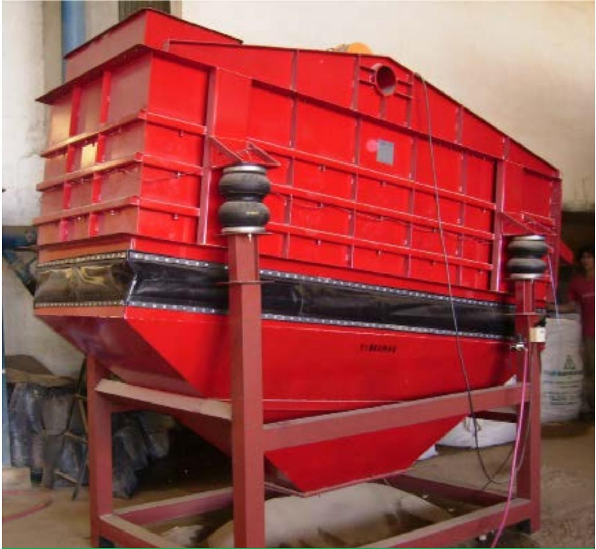
Los modelos ZVMS cuentan con una serie de tamices que le permiten obtener hasta cuatro productos de distinta granulometría. La parte inferior puede darse con una tolva de finos o con una boca a gusto del cliente. Los modelos ZVMS cuentan una potencia instalada que van desde 1 HP Hasta los 10 HP dependiendo del material a separar, de la gra-
